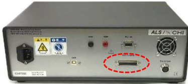
Figure 2-1 25-pin Cell Control terminal of ALS Model
