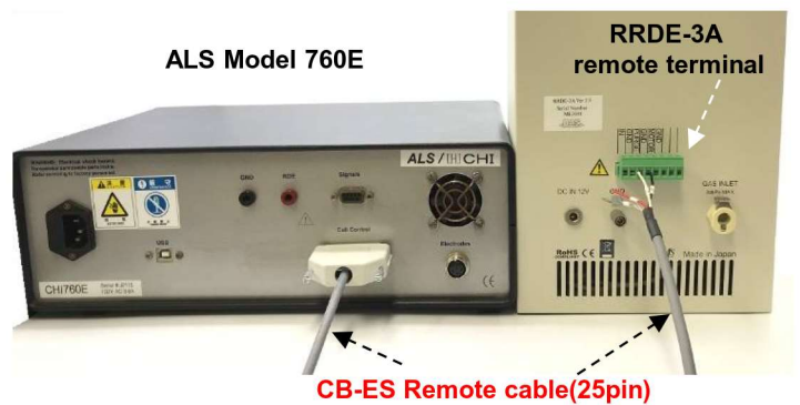
Figure 4-1 Remote connection of ALS Model and RRDE-3A
